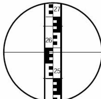
8. Определите расстояние от прибора до рейки
